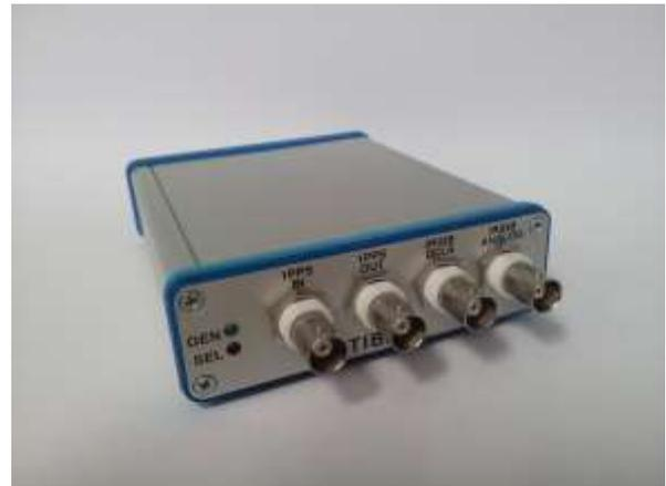
La mise en œuvre du TIB est faite simplement en le connectant sur un port USB d'un PC ou d'un hub USB. Le TIB est alimenté par le port USB et ne nécessite pas d'alimentation externe.
